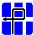
**6.10.1 "Указатель направлений", 6.10.2 "Указатель направления".** Направления движения к пунктам маршрута. На знаках может быть указано расстояние (км) до обозначенных на них объектов, нанесены символы автомагистрали, аэропорта и иные пиктограммы.
